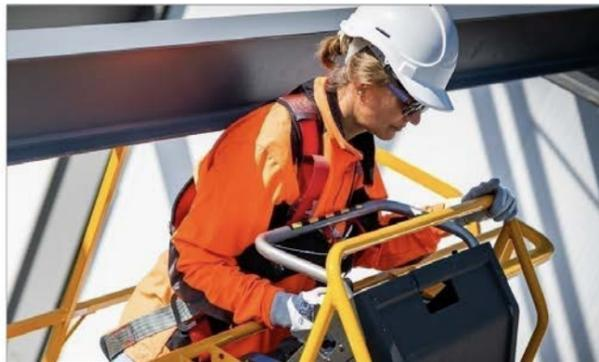
Schutzbügel mit integrierter Not-Halt-Funktion können dabei helfen, Quetschverletzungen durch eine falsche Bedienung der Maschine zu vermeiden.
