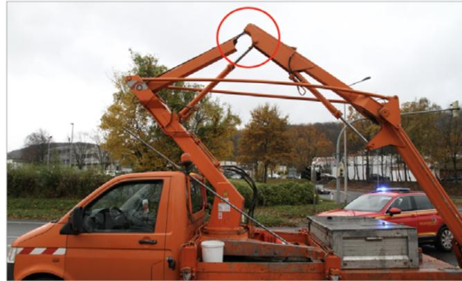
Der Ausleger der Lkw-Hubarbeitsbühne ist gebrochen. Grund dafür sind unzureichende Reparaturen und häufige Fehlbelastungen.
